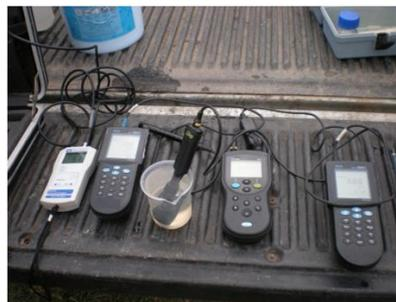
Figura 2: Equipos para mediciones de parámetros in-situ
