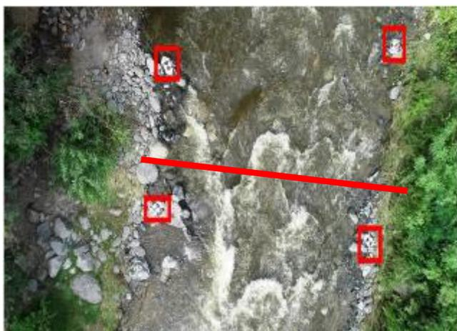
Figura 1: ubicación de puntos de control y perfil batimétrico
